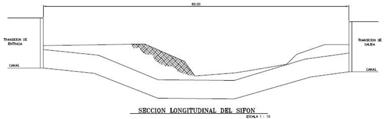
Figura n° 5. 44 Sección típica sifón canal oeste Tramo 1. Fuente: SENARA, 2017.
